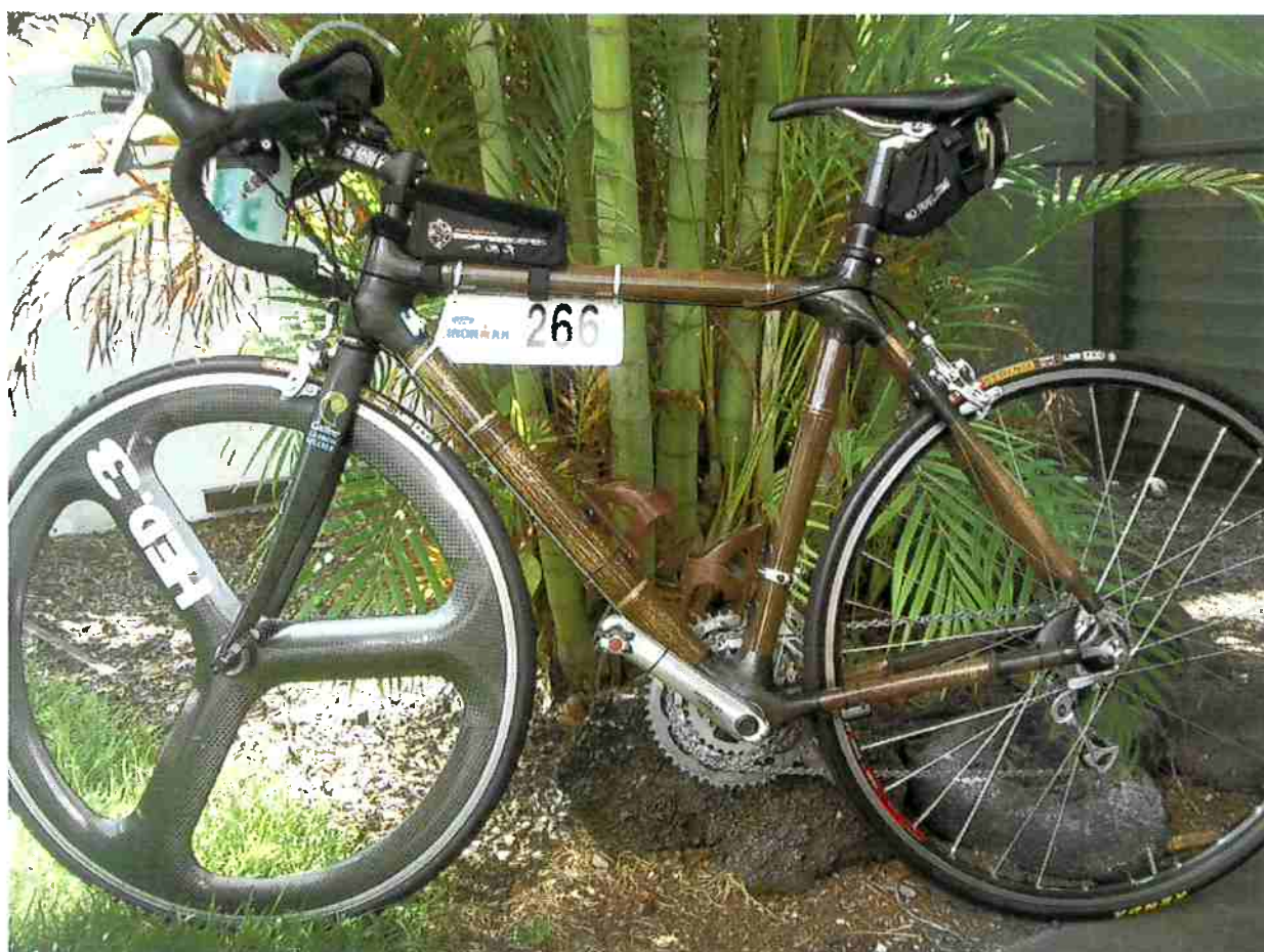
Figura 28 – Bicicleta com quadro de bambu comercializada por Calfee Design [23]
